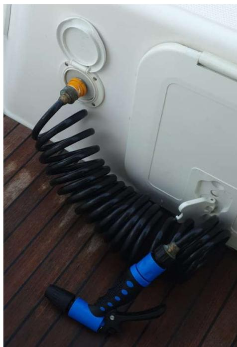
Le bateau est équipé d'une pompe à eau de mer, située dans la poutre arrière dans le cockpit, notée « POMPE DE PONT » sur le tableau électrique. Elle permet à l'aide d'un tuyau en spirale de **rincer le cockpit à l'eau de mer et uniquement en dehors des ports.** De retour à quai, l'ensemble du bateau sera dessalé à l'eau douce, coque et pont.
